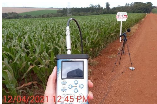
Foto 6 – Equipamentos para medição de ruído e vibração ambiental
